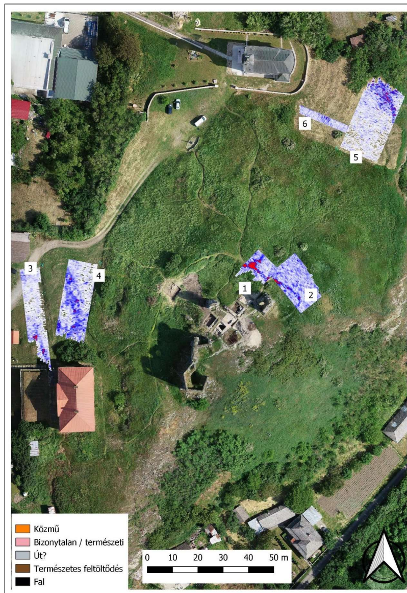
2. ábra: A talajradaros felmérés összesítő térképe (készítette: Lóki Róbert és Takáts Mór Bendegúz)
